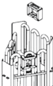
Kuva 4 Fig. 4 Vastuspidikkeet Heating Element Separator
